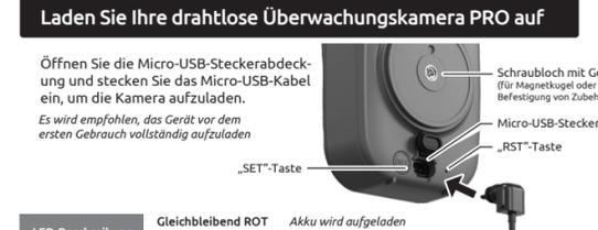
LED-Beschreibung: Gleichbleibend ROT Akku wird aufgeladen, Gleichbleibend BLAU Akku vollständig aufgeladen
