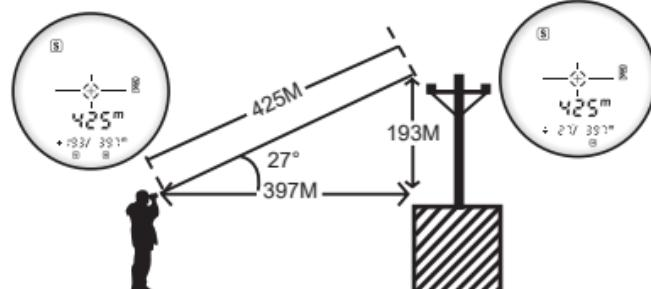
Przełączanie między wysokością a kątem co 0,5 s
