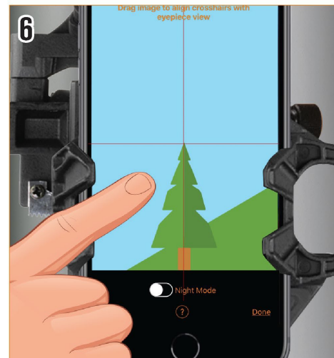
6. Flytta kameravyn tills samma föremål i teleskopet är centrerat i härkorset.
